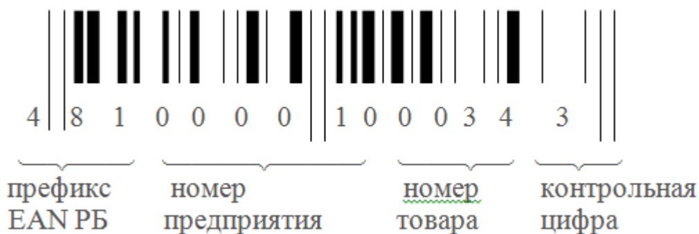
Рисунок. Структура товарного штрихового кода EAN13, применяемого на территории РБ
